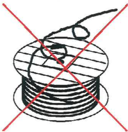
Rys. Błędny sposób odwijania kabla z bębna (ustawienie na jednej flanszy)
