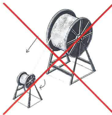
Rys. Błędny sposób przewijania kabla z bębna na inny bęben
